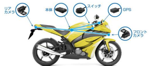
＜バイク用ドライブレコーダー取付イメージ＞
